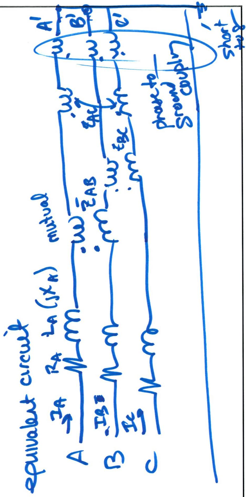
$$\begin{bmatrix} V_{A-A'} \\ V_{B-B'} \\ V_{C-C'} \end{bmatrix} = \begin{bmatrix} \bar{Z}_{AA} & \bar{Z}_{AB} & \bar{Z}_{AC} \\ \bar{Z}_{BA} & \bar{Z}_{BB} & \bar{Z}_{BC} \\ \bar{Z}_{CA} & \bar{Z}_{CB} & \bar{Z}_{CC} \end{bmatrix} \begin{bmatrix} I_A \\ -I_B \\ -I_C \end{bmatrix}$$
